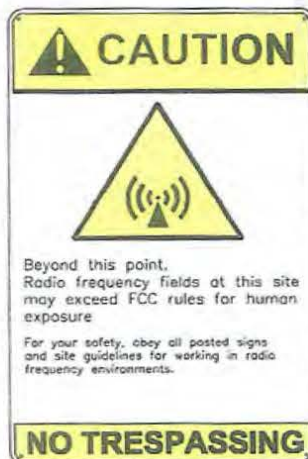
5 TOWER SIGNAGE DETAIL SCALE: N.T.S.
